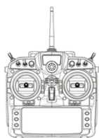
發射機六動以上 直升機模式遙控器 Transmitter with 6 or more channels are required
